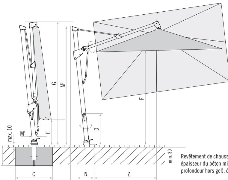
Revêtement de chaussée non fixé max. 10 cm, épaisseur du béton min. 30 cm (tenir compte de la profondeur hors gel), écoulement de l'eau
