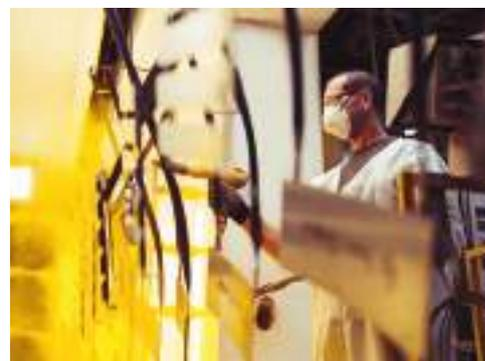
La peinture est **déposée électro-statiquement sur le mobilier pour une couverture optimale**, puis cuite au four à très haute température.
